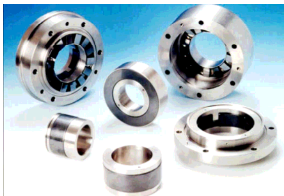
11. ábra Szilíciumkarbid futófelületű radiális siklócsapágy és talpcsapágy elemek (perselyek, és szegmensek, valamint hüvelyek és támasztó tárcsák)
