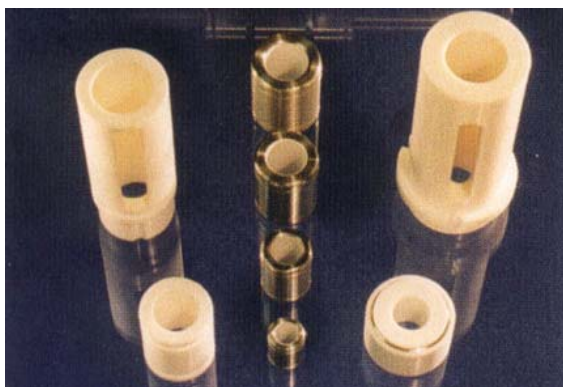
10. ábra Élelmiszeripari gépek kerámia siklócsapágyai
