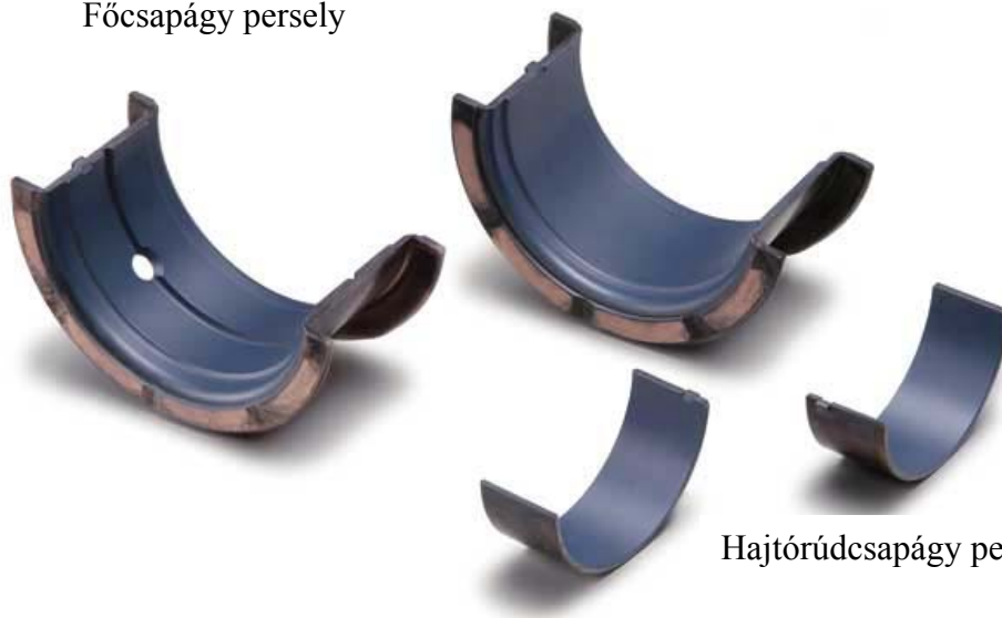
3. ábra Vékony bélésfémme készült belsőégésű motor főcsapágy és hajtórúdcsapágy perselyek
