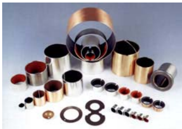
4. ábra Acél siklócsapágyak PTFE futófelülettel. Kenést nem igényelnek
