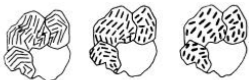
15. ábra A lemezes perlit szemcsésedésének vázlata [16]
