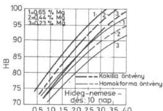
39. ábra A Cu és a Mg hatása a keménységre 10 napos természetes „öregbítés” után [20]
