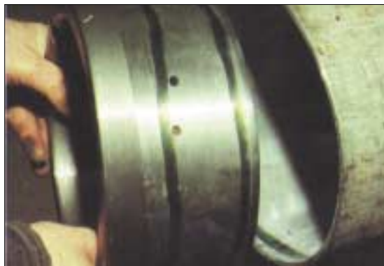
A lemezacél csőkarmantyúvéget most Loctite 638 termékkel rögzítik. Nem kell belső és külső meneteket vágni.
