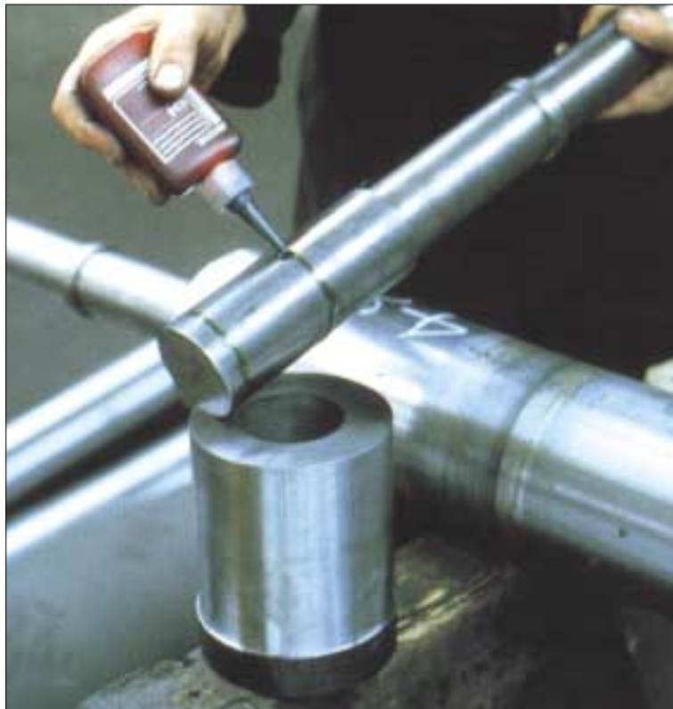
A forgócsap gyűrűk és tengely ragasztós rögzítése 1,5h esztergályási idő megtakarításához vezetett.
