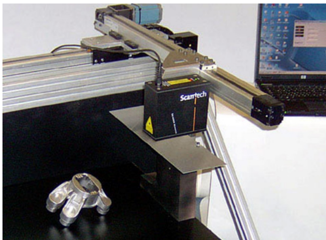
2. ábra. CNC-vezérlésű, X-Y mozgatómechanizmusra szerelt lézerezegység
