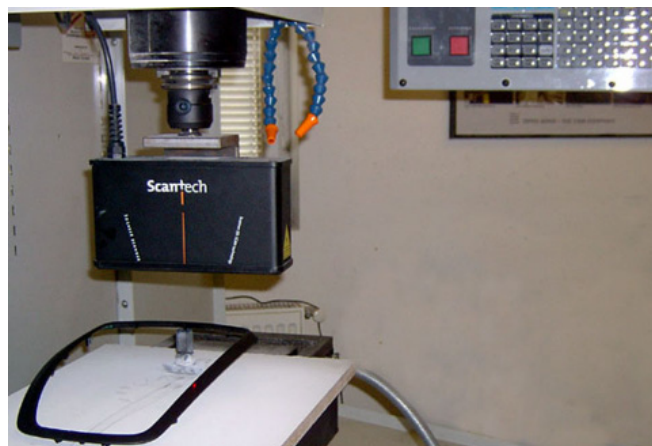
1. ábra. Digitális, térbeli lézerszkennelés HAAS CNC-marógéppel
