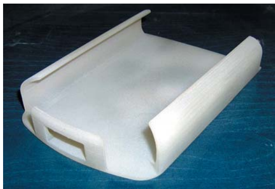
4. ábra. Sztereolitográfiai eljárással készített mestermodell
