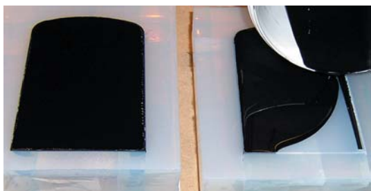
6. ábra. Poliuretán gyanta öntése szilikonszerszámba
