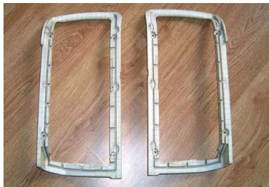
16. ábra: Jobbos/balos LOM-al készített mestermodellek
