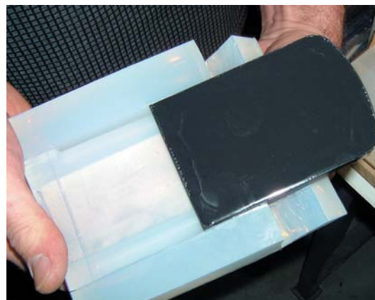
7. ábra. A poliuretánból öntött alkatrész eltávolítása
