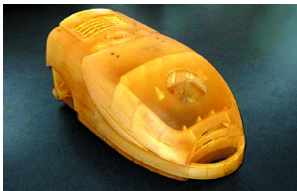
2. ábra. Illeszkedés ellenőrzése Objet/PolyJet modellek összeépítésével
