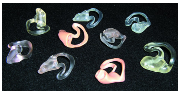
4. ábra. Objet/PolyJet eljárással közvetlenül gyártott fülillesztékek
