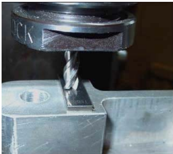
7.10. Ábra. Z eltolás meghatározása mérőhasáb érintésével marógépen
